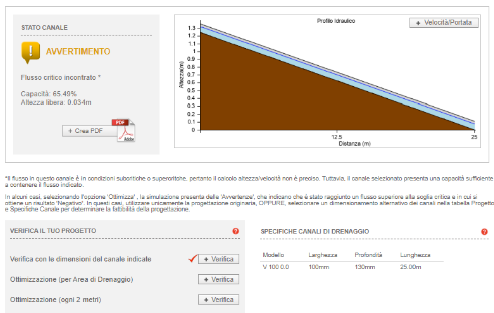
Figura 6: Risultato canaletta grigliata lato nord-ovest della pista ciclopedonale_TR 50 anni
